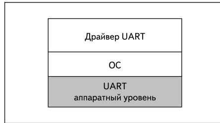
Рис. 5. Иерархическая структура драйверов для работы с интерфейсом UART
