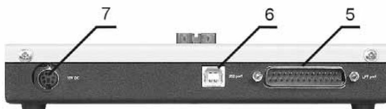
5. Интерфейсный разъем для подключения кабеля LPT;
