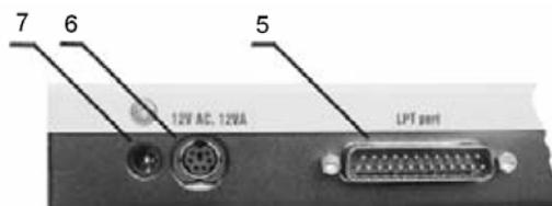
5. Интерфейсный разъем для подключения кабеля LPT;
