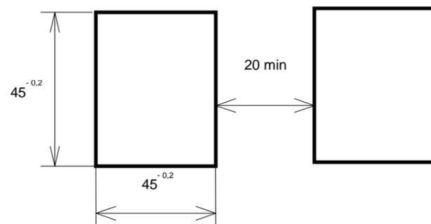
Рис.1. Вырез в щите для крепления прибора.
