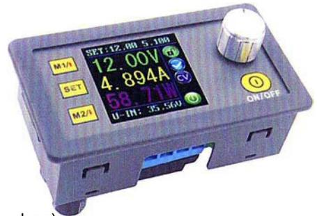
**Примечание:** Вы должны убедиться, что входное напряжение в 1.1 раз выше выходного напряжения. При длительном работе, на мощности близкой к максимальной, необходим принудительный отвод тепла.
